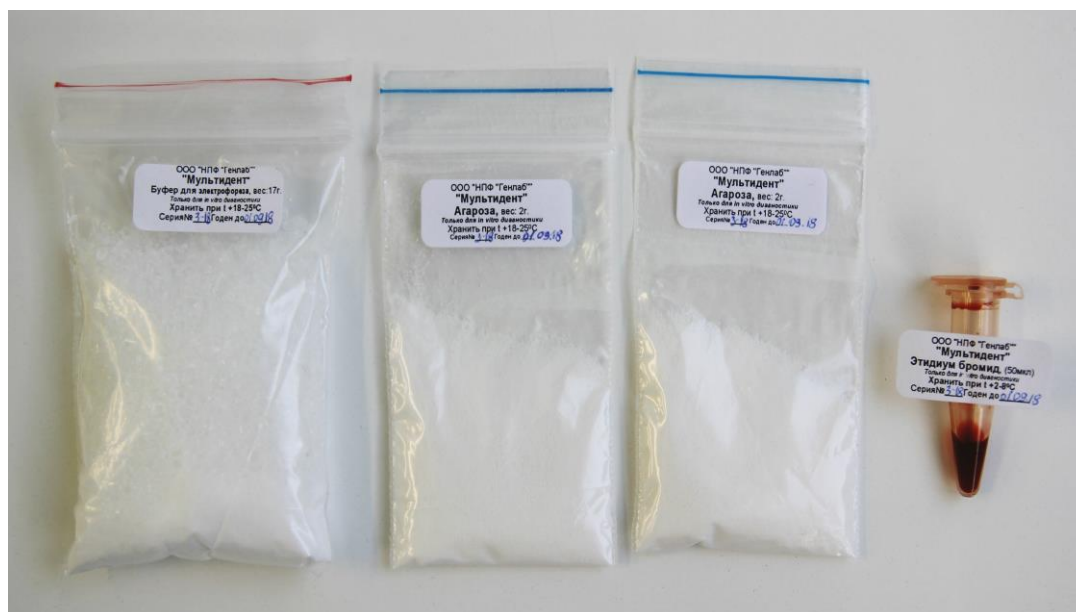
Рисунок 6 - Комплект № 3 – реагенты для электрофореза (буфер для электрофореза 1 пакетик, агароза – 2 пакетика, этидиум бромид – 1 пробирка)
